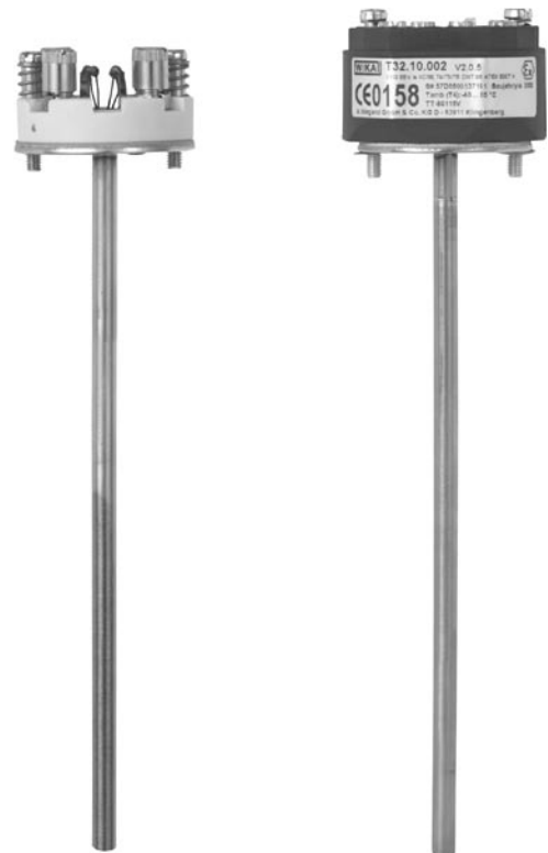
Termopara, elastyczny wkład pomiarowy model TC002 Rys. lewy z skrzynką zaciskową Ø 42 mm Rys. prawy montowany z przetwornikiem
